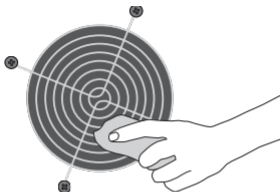
Luftkyld kondensator och kylflänsar
